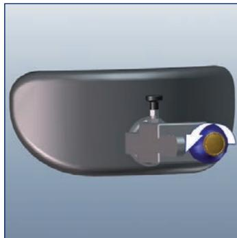
Feststellknopf der Kopfstütze lösen.
