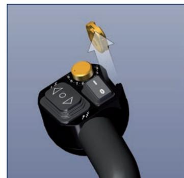
Sicherheitschip für Wegfahrsperrung abziehen.
