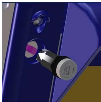
Die Sicherungshalterung herausziehen und defekte Sicherung entnehmen. Neue Sicherung einsetzen, Sicherungshalterung im Uhrzeigersinn drehen und fixieren.
