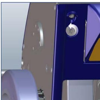
Zum Wechseln der Sicherung die Sicherungshalterung eindrücken und gleichzeitig gegen den Uhrzeigersinn drehen.
