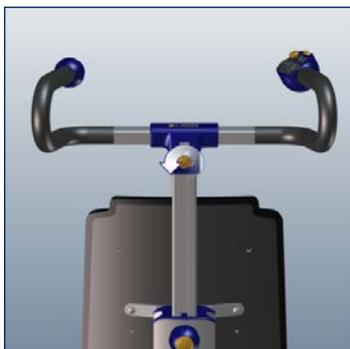
Feststellschraube für Querverstellung entgegen dem Uhrzeigersinn drehen.
