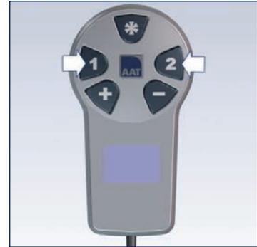
SERVO einschalten - Taste 1 oder 2 drücken! Letzte eingestellte Unterstützungsstufe wird aufgerufen!
