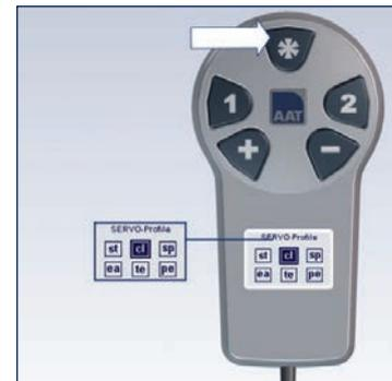
Auswahl eines markierten Fahrprofils erfolgt mit der Taste \*.
