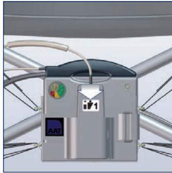
Bediengerät in Tasche einsetzen.
