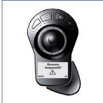
Feststellbremsen bei Bedarf aktivieren und Displayanzeige entsprechend bestätigen.
