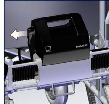
Die Powerleitung kann aus der Antriebseinheit und aus dem Akku-Pack ausgesteckt werden.
