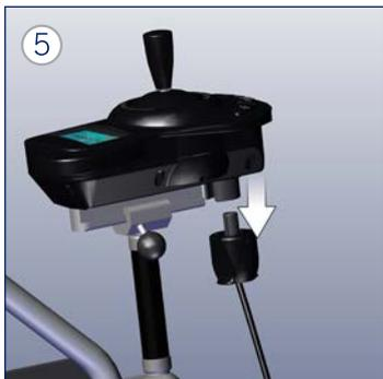
Das andere Ende des Spiralkabels aus der Buchse des Bediengeräts ausstecken.
