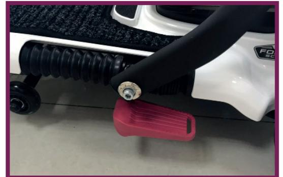
Durch den Fußhebel ist das Einklappen in zwei Handgriffen möglich.
